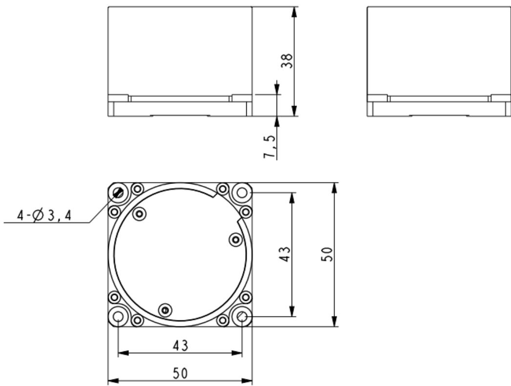
图 1 FOG-200B 型光纤陀螺外形及安装示意图
