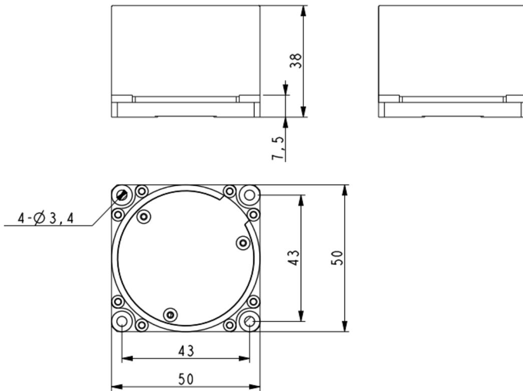
图 1 FOG-200D 型光纤陀螺外形及安装示意图
